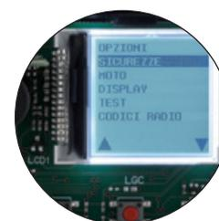
AUTOPROGRAMMABILE TRAMITE DISPLAY LCD GRAFICO ELDOM34/6
